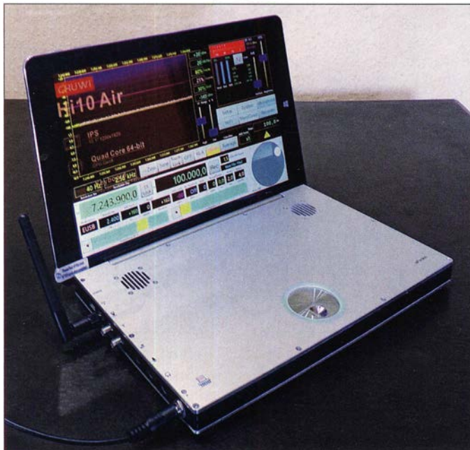
Bild 1: Der Reuter RDR53 sPocket; zum Lieferumfang gehören: Schutztasche, WLAN-Antenne, SMA/BNC-Patchkabel, Netzteil für das Tablet, 12-V-Kabel für das Grundgerät, Powerbank mit 12-V-Adapter, USB-Kabel und USB-Stick mit Software
