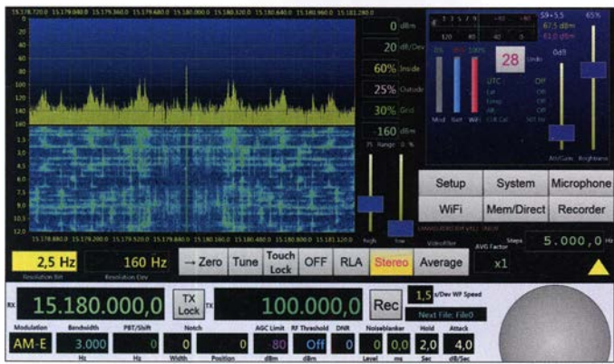
Bild 6: Die schnell reagierende Spektrumsdarstellung überzeugt auch in hoher Auflösung; informativ sind auch die differenzierten Angaben zum Empfangspegel.
