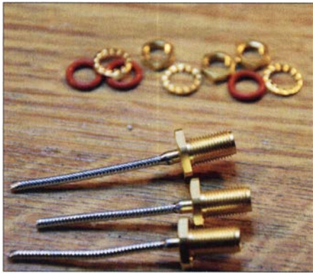
Bild 4: Zum Einbau vorbereitete Kabelstücke mit angelöteten SMA-Buchsen
