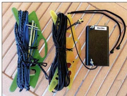
Bild 6: Zwei Haspeln Wire Winders mit aufgewickeltem Strahler und Radials (links), 10 m Koaxialkabel RG174 (Mitte) neben der Umschaltbox und den lösbaren Kabelbindern
