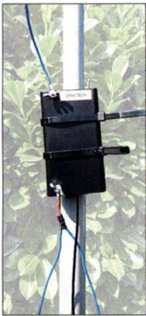
Bild 3: Die Befestigung des Gehäuses erfolgt beim Auseinanderziehen des Mastes mit lösbaren Kabelbindern. Strahler (oben) und Radials (unten) werden über ihre Kabelschuhe und Flügelmuttern angeschlossen.
