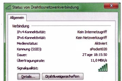
Bild 10: Nach erfolgter Eingabe des Netzwerkschlüssels zeigt der Netzwerk-Status eine erfolgreiche Netzwerkverbindung.
