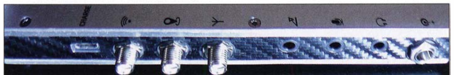
Bild 3: Die Anschlussleiste (v. l. n. r.): Stromversorgung für Tablet, WLAN-Antenne, GPS-Antenne, RX/TX-Antenne, Morsetaste, Mikrophon, Kopfhörer, Stromversorgung
