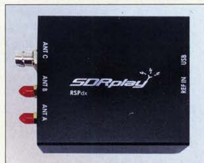
Der RSPdx hat ein Kunststoffgehäuse und verfügt über drei per Software wählbare Antenneneingänge.
