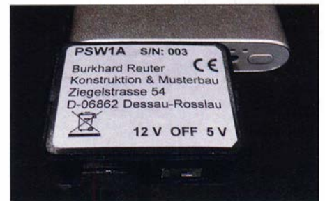
Bild 2: Ein pfiffiger Adapter nutzt beide Ausgänge der Powerbank und stellt 12 V zur Verfügung.
