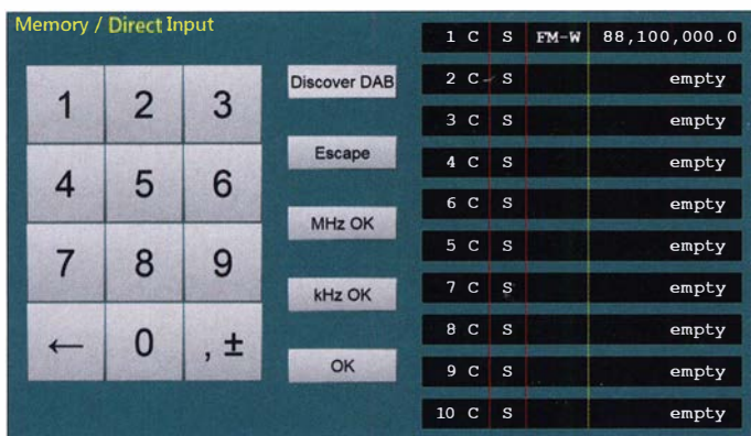
Bild 5: Die Anwahl von DAB-Stationen erfolgt durch Antippen der per Senderschlauf befüllten Speicher.
