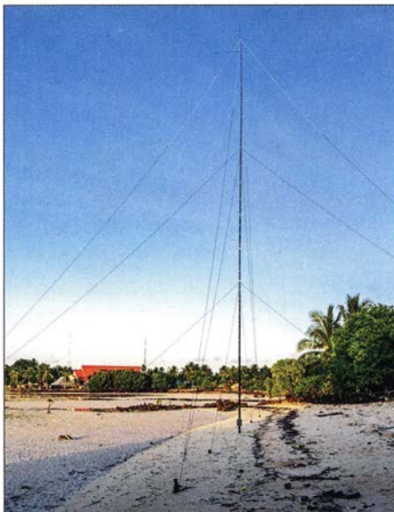
RA6LBS-Vertikal für 30 m bis 160 m am Strand von Tarawa
