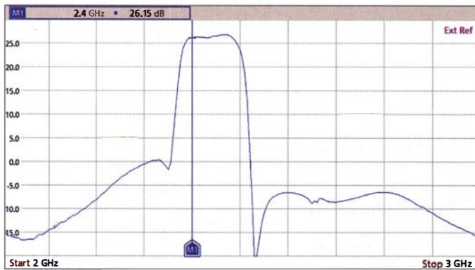
Bild 15: Spektrum des Ausgangssignals des Treiberverstärkers bei einer Ausgangsleistung von 0,5 W (PEP)
