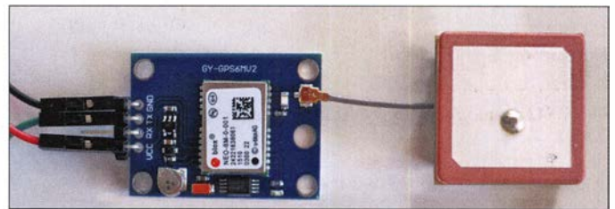
Bild 9: Detailaufnahme des U-blox NEO-6M mit angeschlossener GPS-Patch-Antenne
